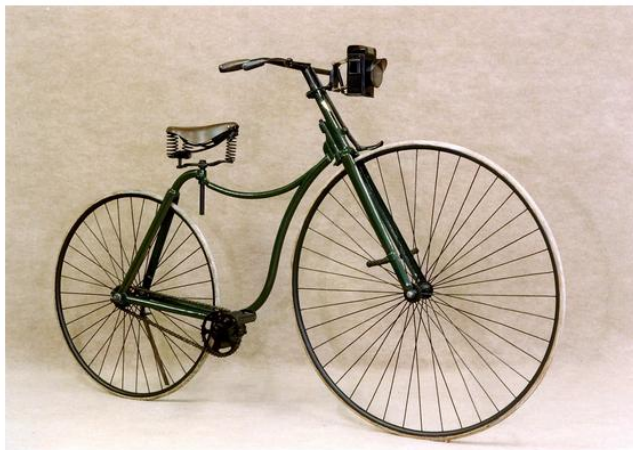
В 1880≈90-е годы было разработано несколько моделей «безопасного» велосипеда с цепной передачей, Rover – наиболее удачный и коммерчески успешный. Позже фирма перешла на выпуск автомобилей.
